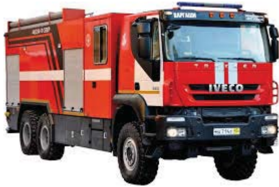
Рис. 15. Пожарная автоцистерна АЦ-С 8,0-70 на шасси (6339)
