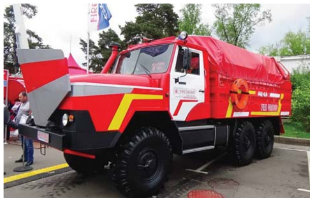
Рис. 8. Специальный водоплавающий пожарный автомобиль АЦ 4,0
