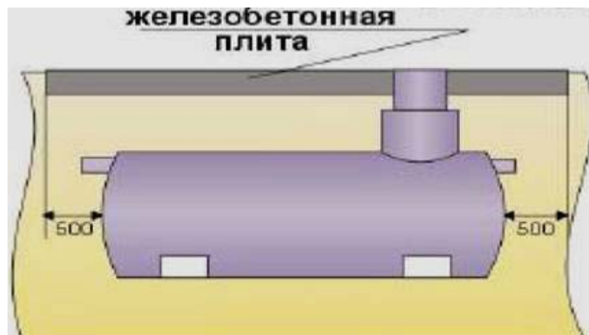
Рис. 1. Установка плиты над подземным пожарным резервуаром
