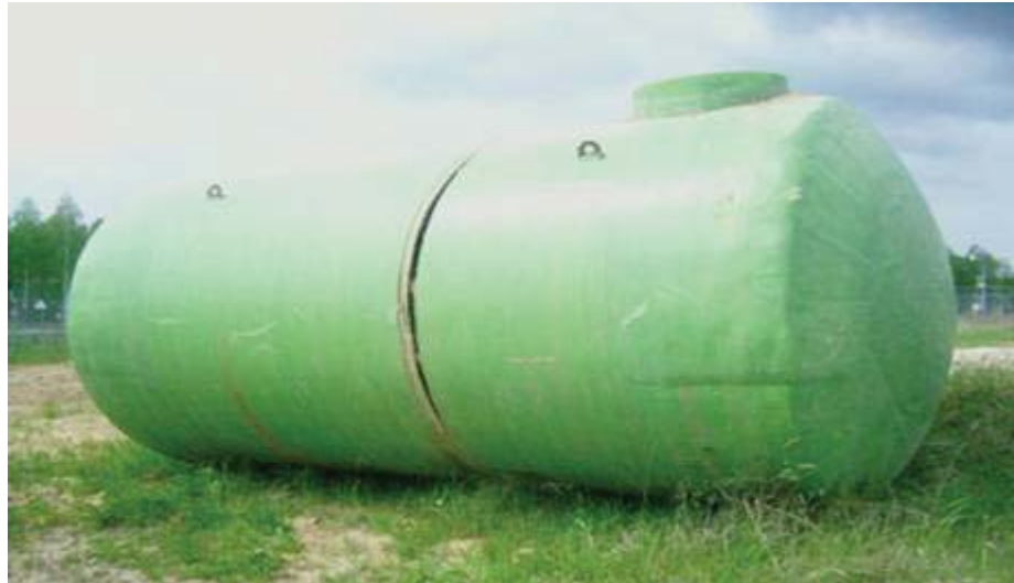
Рис. 2. Характерное разрушение пластмассового резервуара
