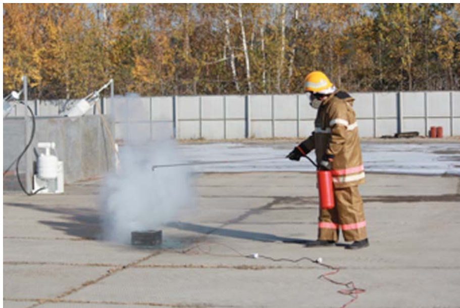
Рис. 2. Тушение литиевых аккумуляторных батарей подачей жидкостного состава из огнетушителя
