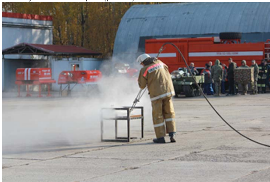
Рис. 1. Работа установки гидроабразивной резки и пожаротушения «Гюрза»
