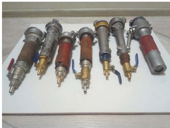
Рис. 2. Восстановленные стволы с малым расходом воды из неисправных стволос (PC-A, PC-B, CPK-50, PC-50, KP-B, PCK-50)
