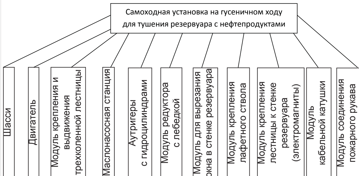
Рис. 9. Состав предлагаемой самоходной установки для тушения резервуара с нефтепродуктами
