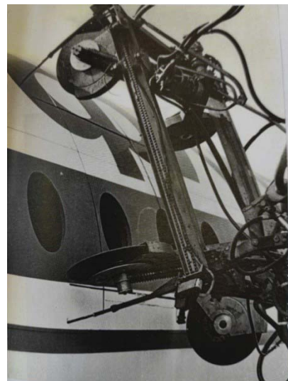
Рис. 12. Вырезание окна в фюзеляже самолета с помощью корундовых дисков
