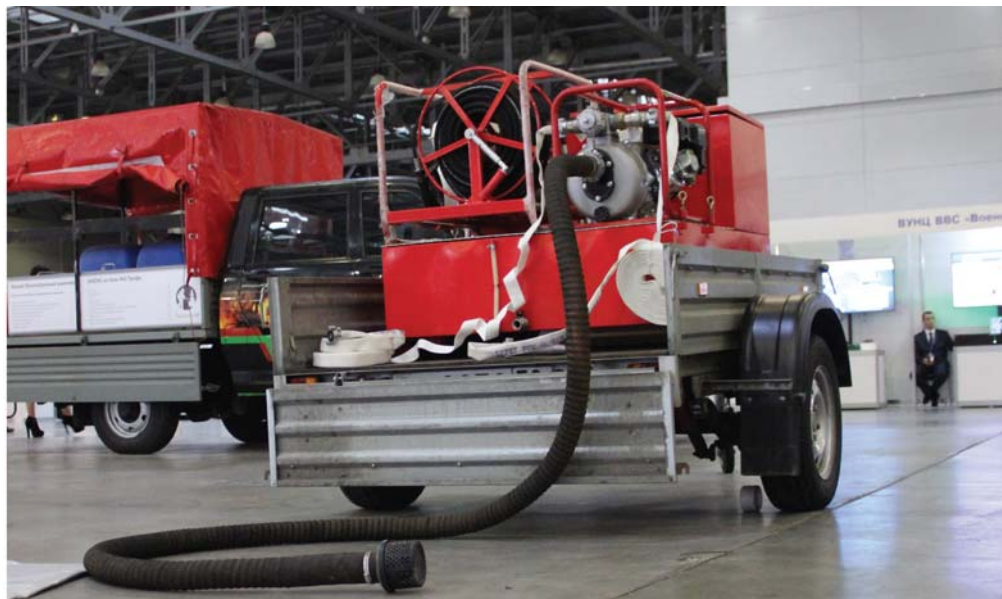
Рис. 5. Мобильный пожарный модуль МЛПК на шасси УАЗ
