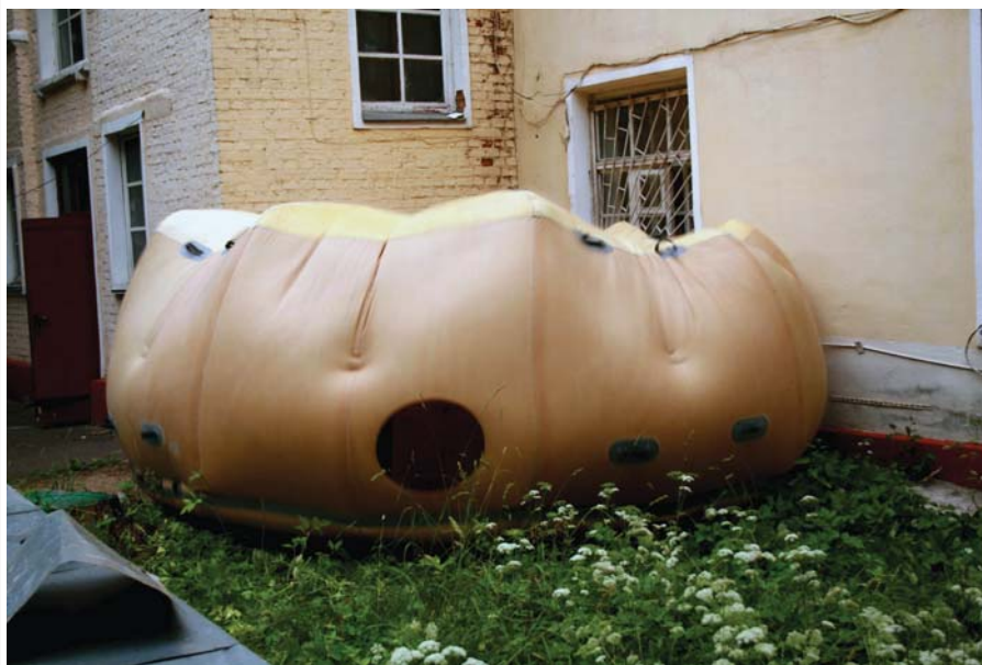
Рис. 4. Результат падения грузомкета массой 100 кг с высоты 20 м в центр мата
