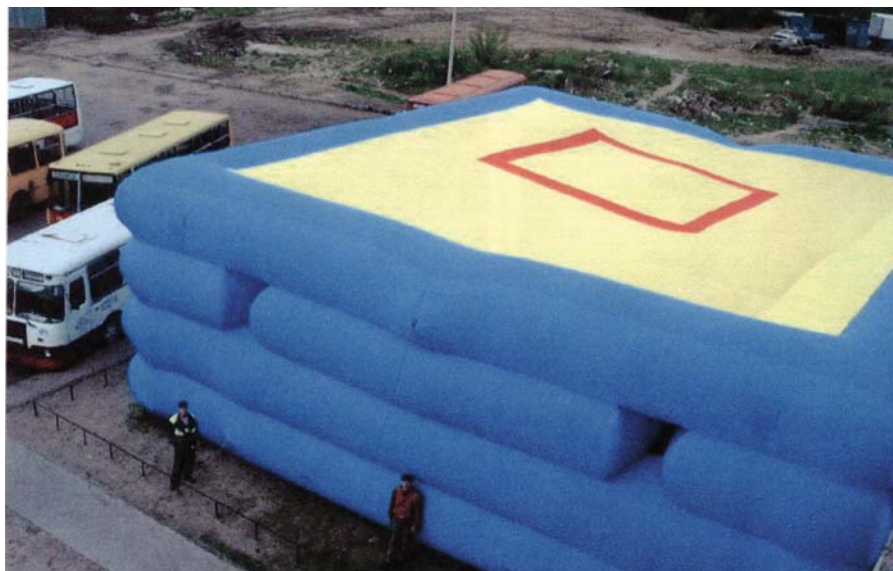
Рис. 3. Пневматический мат «Каскад-16»
