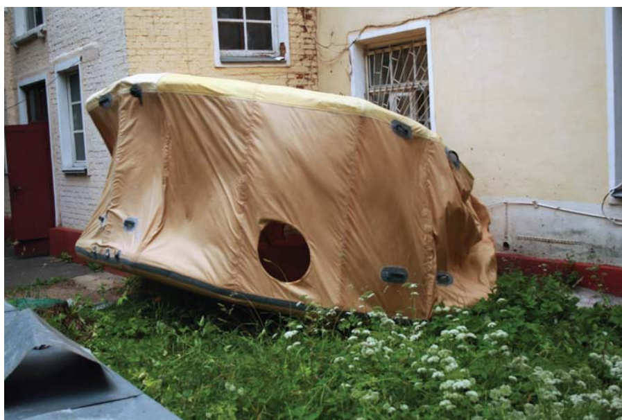
Рис. 4. Результат падения грузомкета массой 100 кг с высоты 20 м в центр мата
