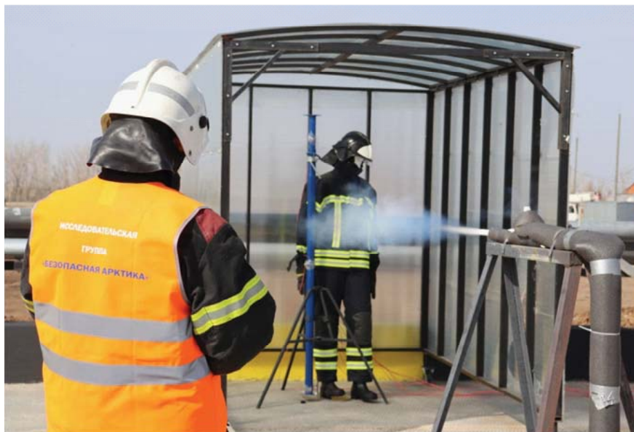
Рис. 5. Проведение оценки влияния воздействия газового облака криогенной жидкости на боевую одежду пожарного
