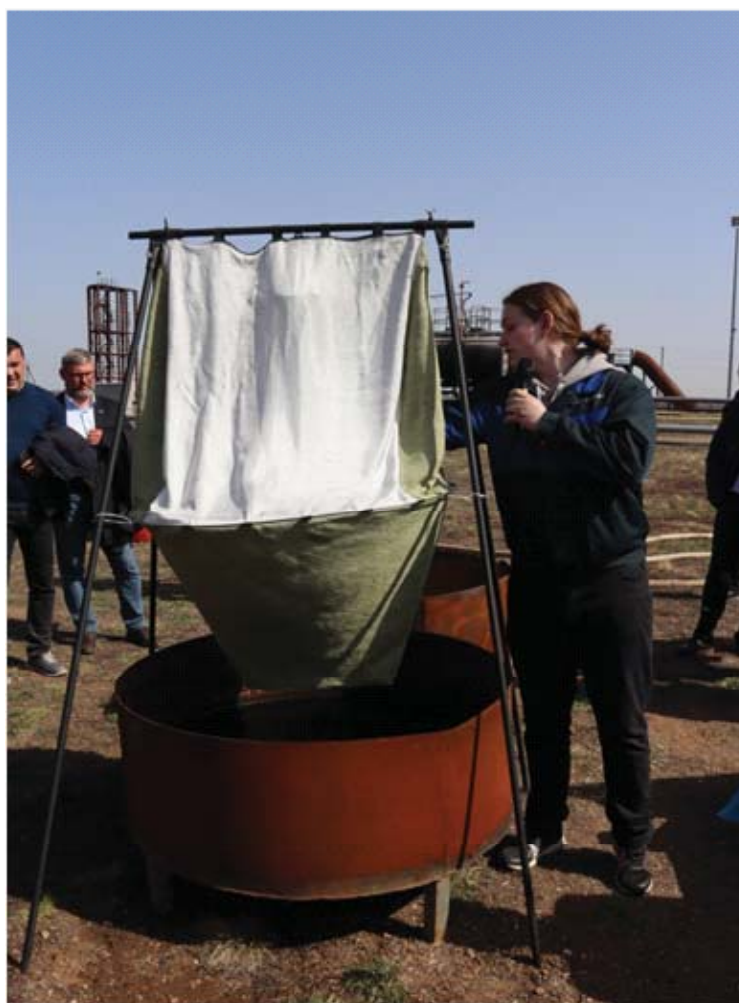
Рис. 6. Проведение испытаний по методу ликвидации разлива нефтепродуктов с водной поверхности с помощью автономно полученного сорбента из терморасширенного графита
