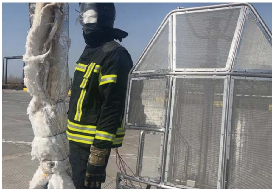
Рис. 4. Оценка эффективности применения водопленочных экранов (на фото представлен теплозащитный экран Согда 1В (им. Е.Н. Чернышева) производства ООО «СпецПожТех»)
