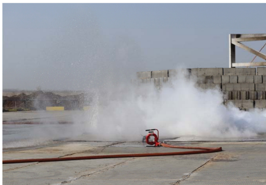
Рис. 3. Регазификация газового облака при помощи веерных завес
