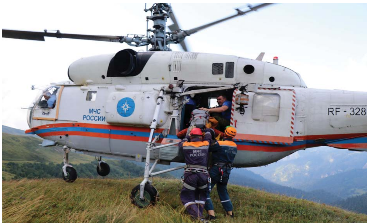
Рис. 1. Десантирование с борта вертолета без применения технических средств
