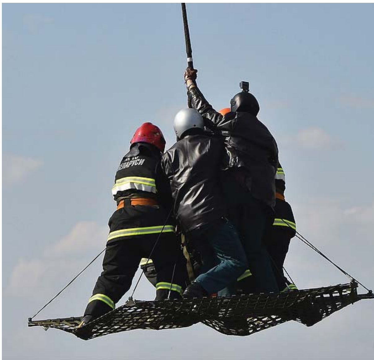
Рис. 6. Транспортировка на внешней подвеске вертолета с помощью подвесной платформы
