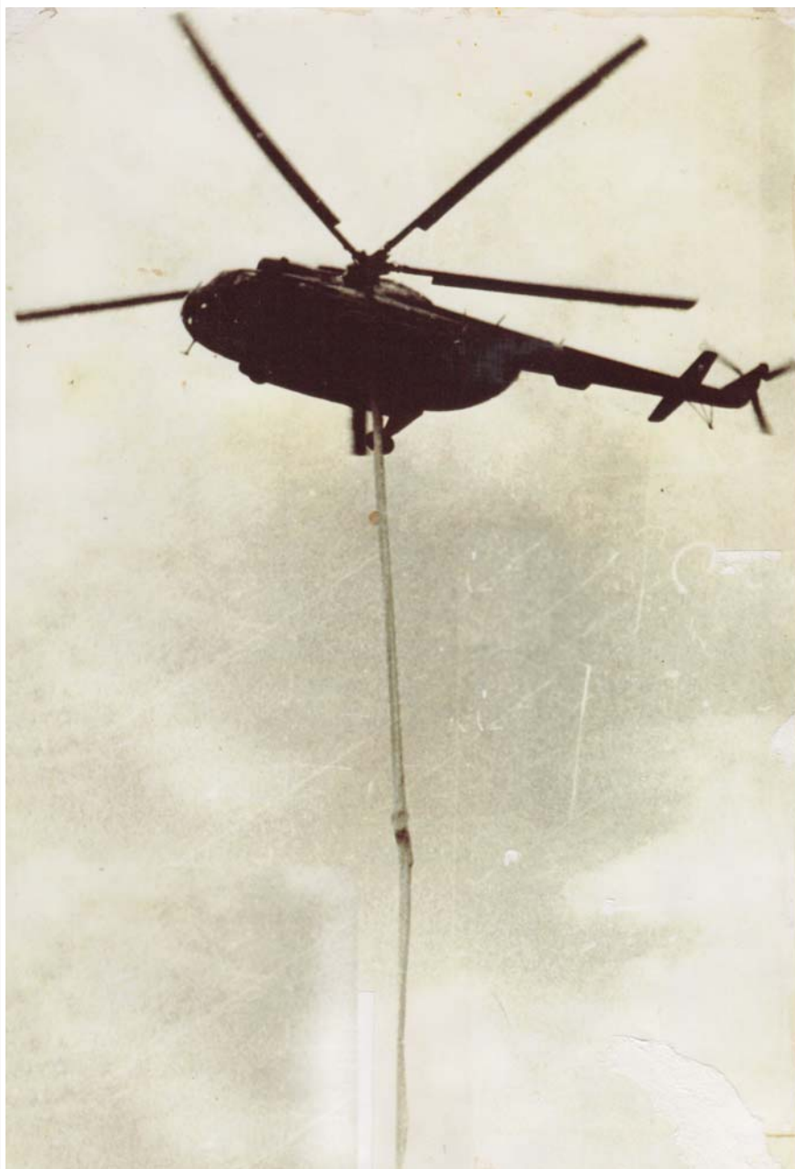
Рис. 5. Десантирование с борта вертолета с помощью устройства на базе эластичного спасательного рукава (фото восстановлено)
