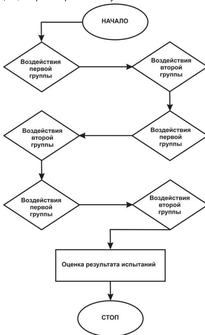
Рис. 3. Алгоритм испытаний одного образца по естественной схеме
