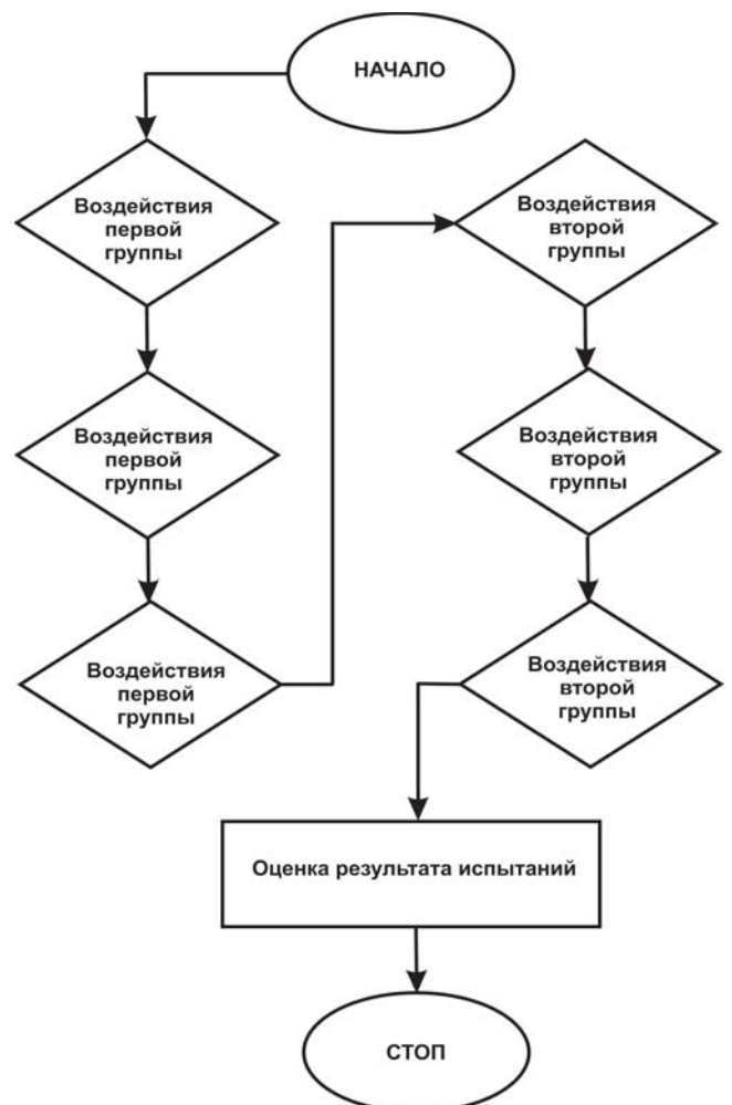
Рис. 1. Алгоритм испытаний одного образца по последовательной схеме
