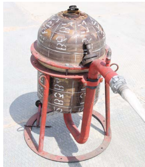
Рис. 5. Установка импульсного пожаротушения (УИП), УПАТ-60
