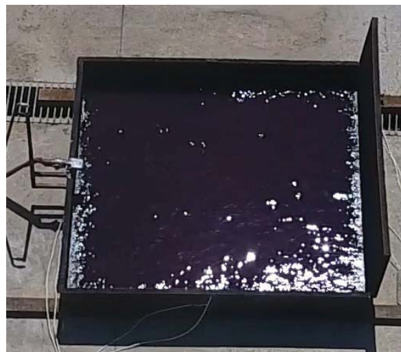
Рис. 2. Модельный очаг квадратной формы
