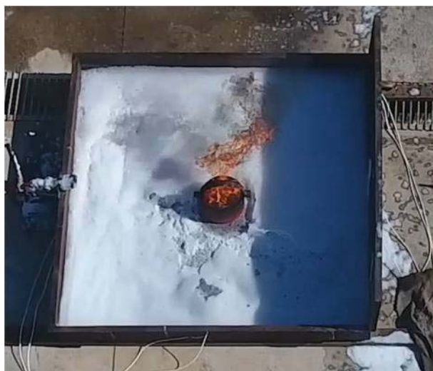
Рис. 6. Установка горящего тигля в модельный очаг
