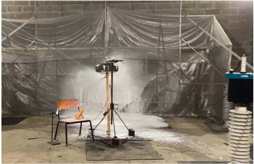
Рис. 5. Экспериментальное исследование МУПТВ подвешного типа и форсунки с к-Фактором 2 л/(мин · √бар)
