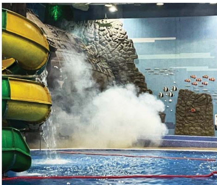
Рис. 2. Имитация пожара в аквазале с помощью дымогенератора
