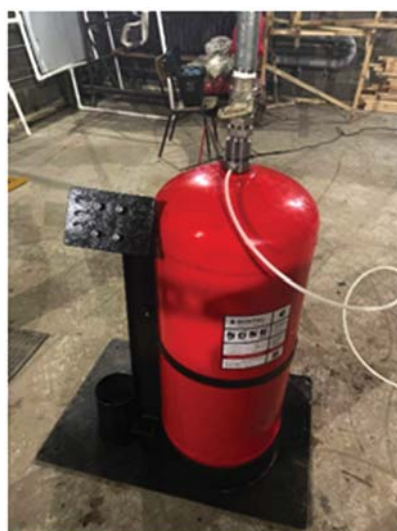
Рис. 2. Модульная установка пенного пожаротушения и форсунка с к-Фактором 3,2 л/(мин · √бар)
