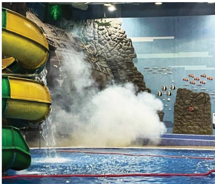
Рис. 2. Имитация пожара в аквазале с помощью дымогенератора
