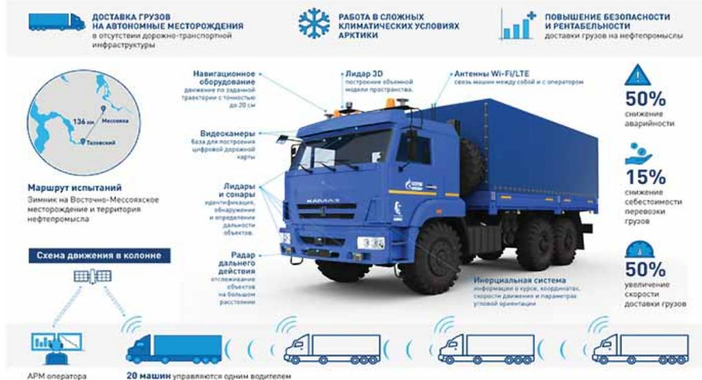
Рис. 5. Результаты испытаний беспилотных автомобилей КамАЗ
