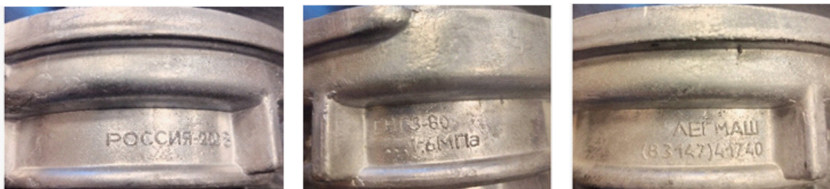
Рис. 3. Место размещения маркировки на пожарной соединительной головке
