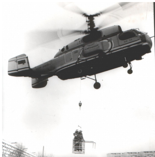
Рис. 2. Спасение людей вертолетом среднего класса Ка-32, оборудованном кабиной ТСК-1
