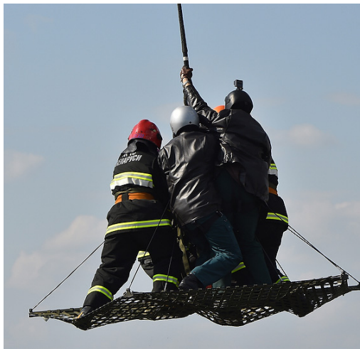
Рис. 1. Транспортировка на внешней подвеске вертолета с помощью подвесной платформы
