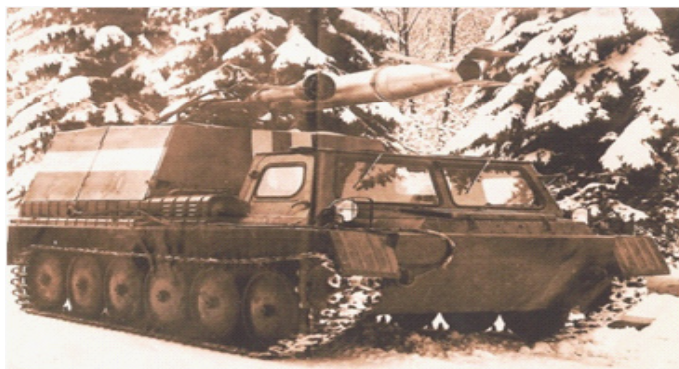
Рис. 3. Самоходный лафетный ствол (СЛС-100) на базе гусеничного тягача ГТС СМ
