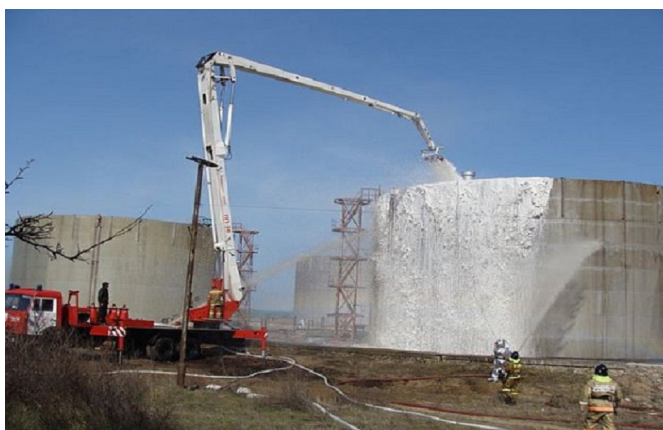
Рис. 1. Тушение нефтеналивного резервуара с перекошенной крышей
