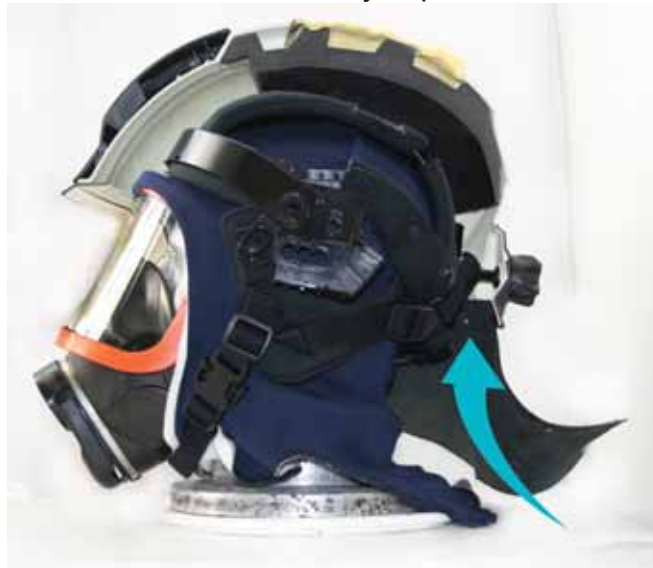
Рис. 11. Проход холодного воздуха в подкасочное пространство сзади
