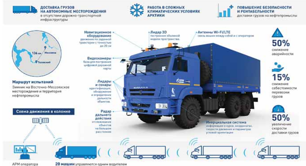
Рис. 5. Результаты испытаний беспилотных автомобилей КамАЗ
